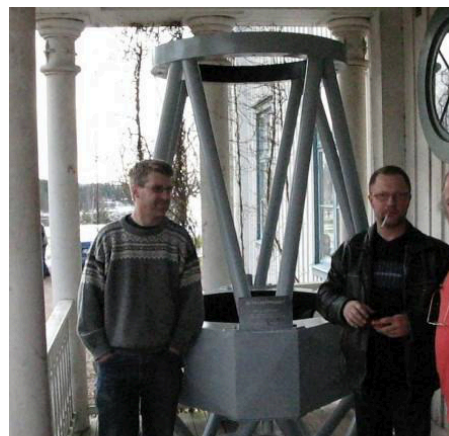
Ett 30 tums spegelteleskop med fackverkstrukturen som ska hålla upp spegelsystemet. Lars Engström t.v. och Mats Yderstig t.h.
